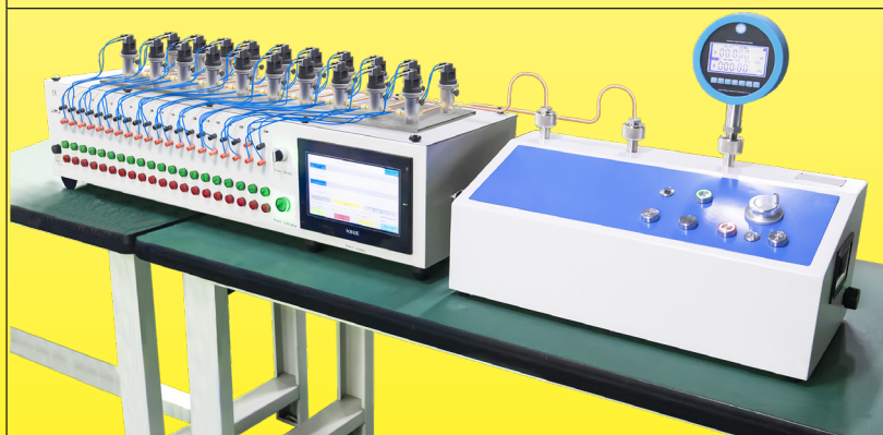
Vérification de l'étalonnage des pressostats
